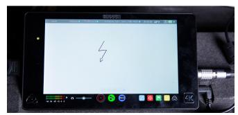
Durch das Drücken des roten «Rec-Buttons» am unteren Rand des Aufnahmegeräts wird die Aufnahme gestartet und auch beendet. Abspielen über "Play"
