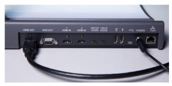
Die Dokumentenkamera wird am Strom angeschlossen. Das HDMI Kabel wird bei «HDMI OUT» angeschlossen und mit dem Aufzeichnungsgerät verbunden.
