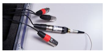
Das Mikrofon (Headset) wird an einem der schwarzen XLR Stecker eingesteckt.
