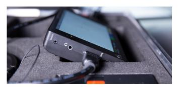
Das HDMI Kabel wird beim Aufzeichnungsgerät bei «HDMI IN» eingesteckt.
