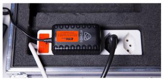
Die Steckerleiste im Aufzeichnungskoffer wird mit Strom versorgt. Anschliessend können alle Geräte Strom von der Steckerleiste beziehen.
