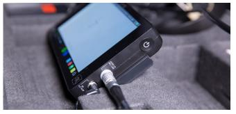
Auf der anderen Seite ist das Aufzeichnungsgerät bereits an den Strom sowie an die Mikrofonausgänge angeschlossen. Hier befindet sich auch der Knopf, um das Aufzeichnungerät ein- und auszuschalten.
